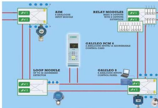
Für viele Anwendungen geeignetes SIL-konformes Gaswarnsystem (SIL = Sicherheits-Integritäts-Level) gemäß der Anforderungen der Europäernorm EN 50402 zum Thema Funktionale Sicherheit.
